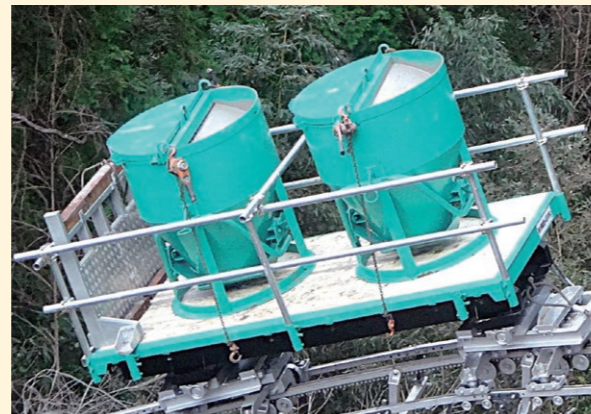
生コンホッパー (最大0.5㎡ X 2) + 長尺物運搬台仕様
