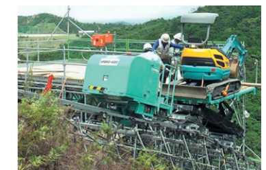
平成16年4t/45°超大型モノレール「単線軌道」を開発
