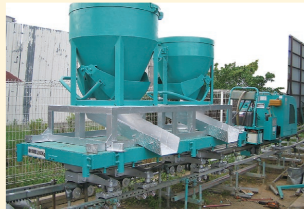
スロープ搬出口付生コンホッパー装備台車 (最大0.5㎡ X 2)
