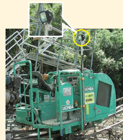
工事ライト装備
