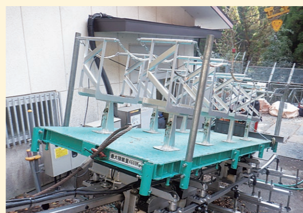
物流台車に着脱式乗用座席を装着
