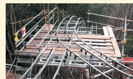
3条ワンタッチ切替ポイント(左曲線切替状態)
