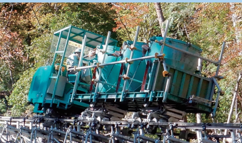
0.5m生コンホッパー×3台
