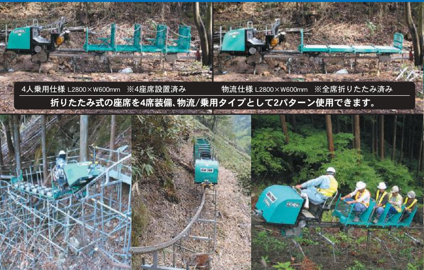
法面工事資材を運搬。最大斜度48度。 法面工事で資機材を運搬。 乗用仕様にて人員輸送。
