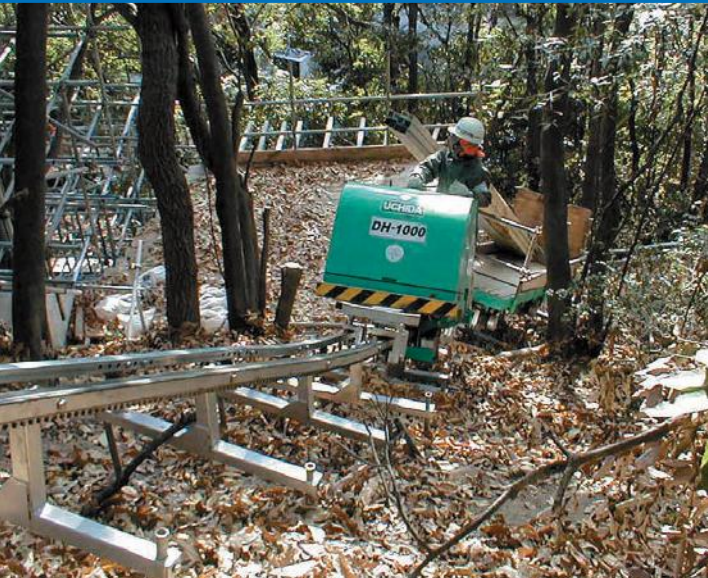
台車に長尺仕様運搬中
