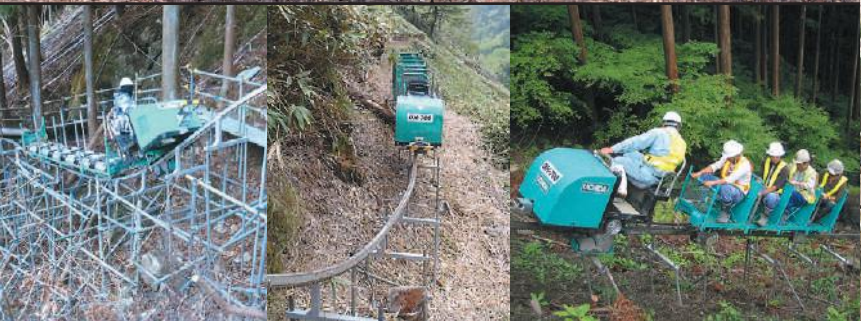
法面工事資材を運搬。最大斜度48度。 法面工事で資機材を運搬。 乗用仕様にて人員輸送。
