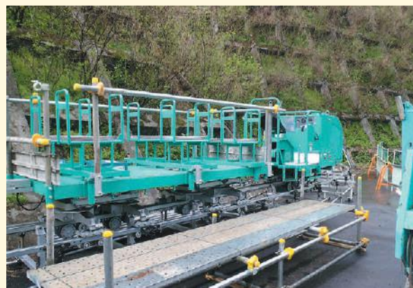
物流台車・フラットデッキダンプ台車に乗用座席装備
