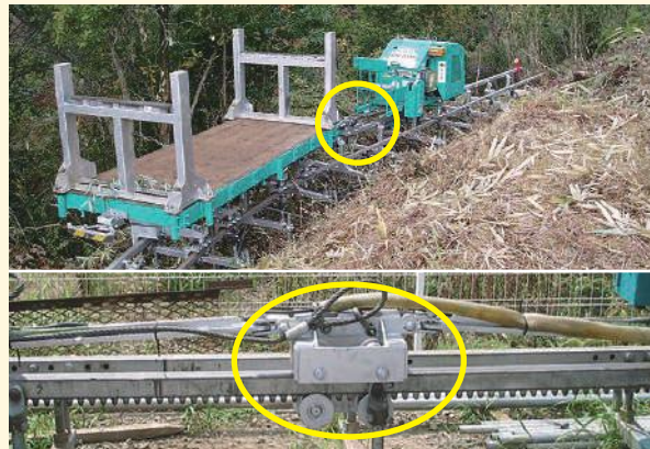
長尺資材運搬台車仕様(最大8m)
